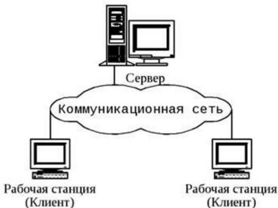
Рисунок 7 – Схема двухуровневой архитектуры приложения
