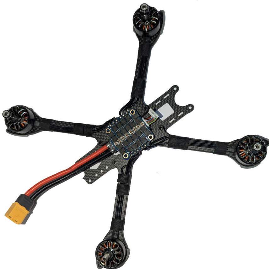
Рисунок 7 – Установка моторов на раму и подключение их к ESC
