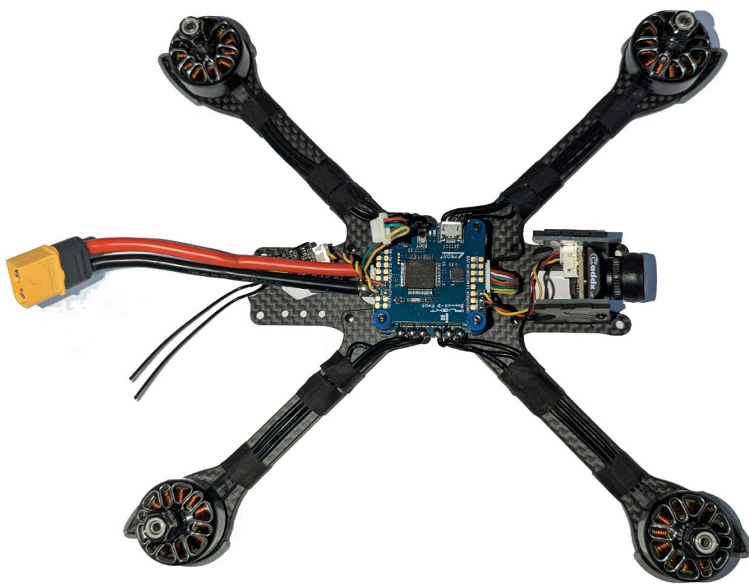
Рисунок 8 – Установка контроллера, камеры и передатчика
