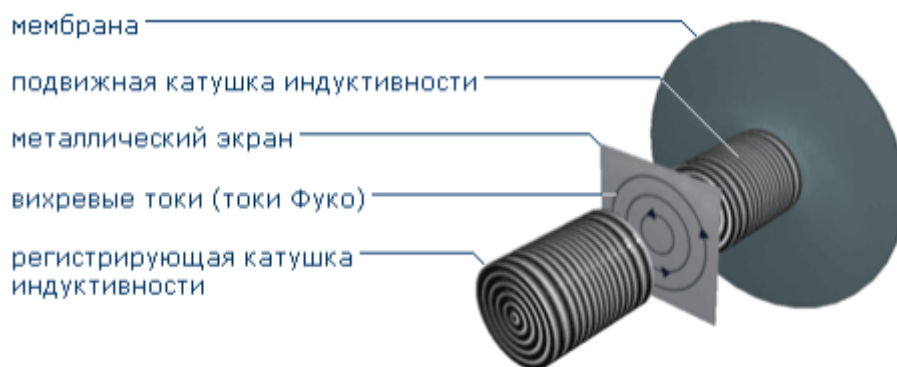
Рисунок 1.9 – Принципиальная схема индукционного преобразователя давления
