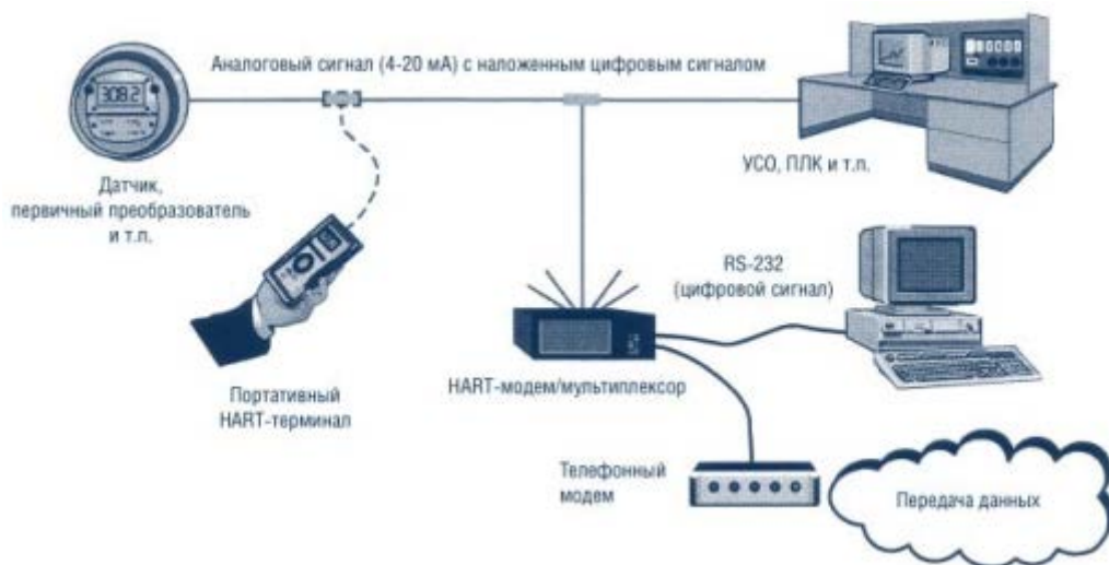
Рисунок 1.15 – Типовые HART-компоненты и схема их подключения
