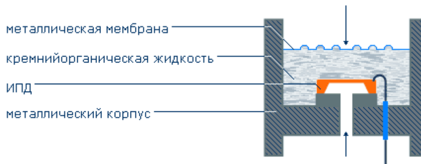
Рисунок 1.5 – Преобразователь давления, защищенный от измеряемой среды посредством коррозионностойкой мембраны
