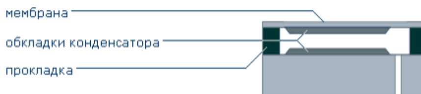
Рисунок 1.6 – Емкостной керамический преобразователь давления, выполненный методами микромеханики
