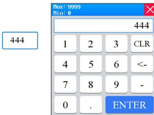
Рисунок 15 – Редактирование переменной в микроконтроллере STM32 через Kinco HMI
