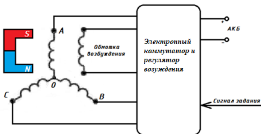
Рисунок 4 – Схема подключения обмоток
