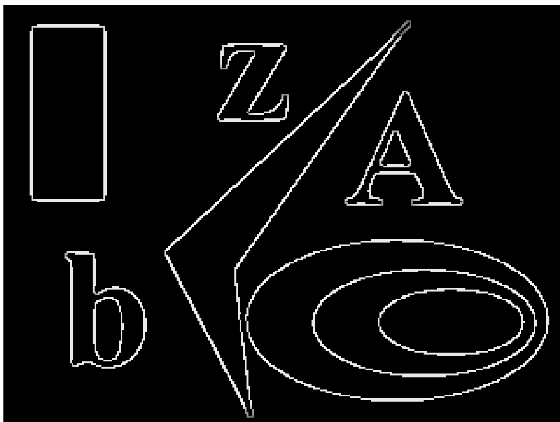
Рисунок 10 – Пример результата обработки изображения с использованием алгоритма Кэнни
