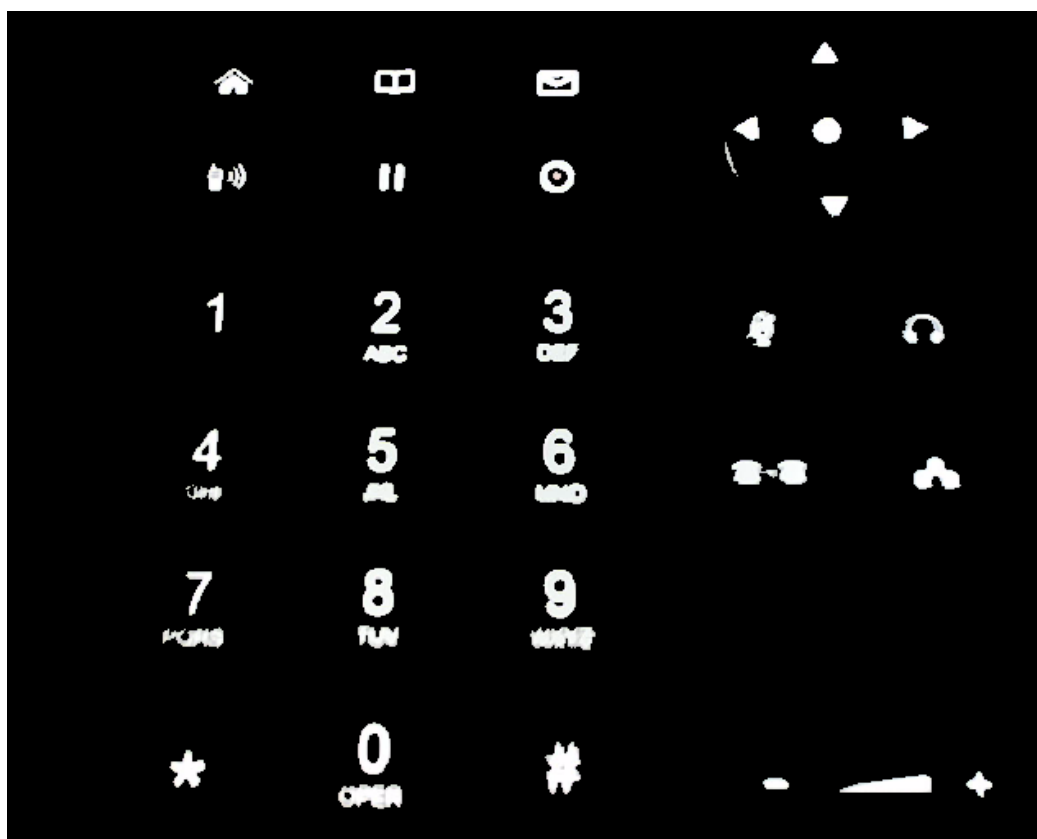
Рисунок 9 – Пример фильтрации изображения по цвету. При съемке лицевой панели стационарного телефона и проведении фильтрации по цвету, близкому к белому, получаем изображение только нанесенных белой краской значений
