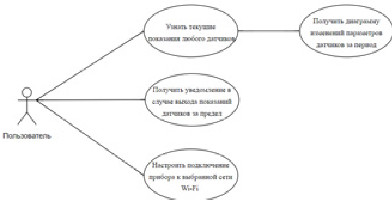
Рисунок 2.1 - UML диаграмма взаимодействия пользователя с программно-аппаратным комплексом
