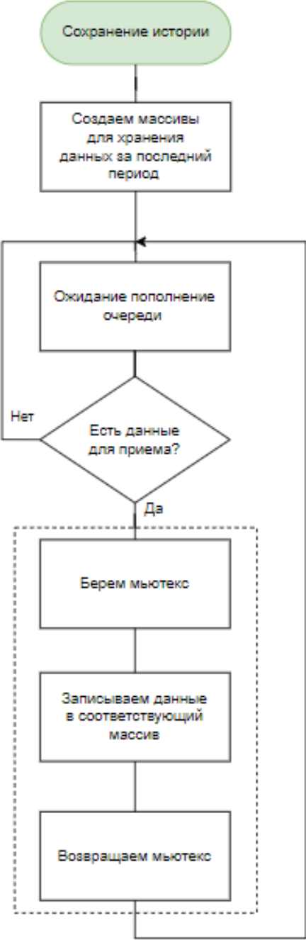
Рисунок 4.5 - Схема алгоритма сохранения истории
