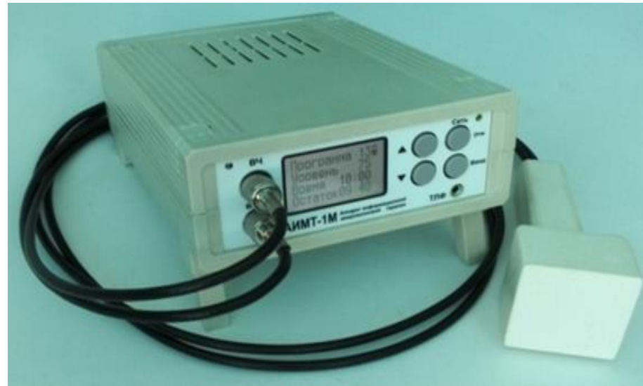
Рис.1. Устройство моделирования микроволнового излучения Солнца
