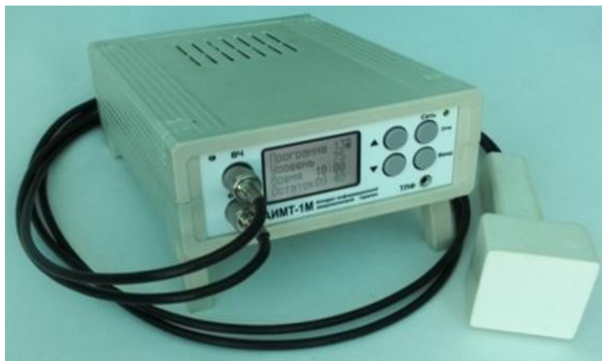
Рис.5 - Устройство моделирования микроволнового излучения Солнца
