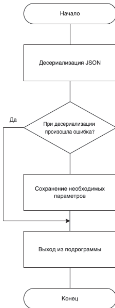
Рисунок 5 – Общий алгоритм десериализации полученных JSON записей
