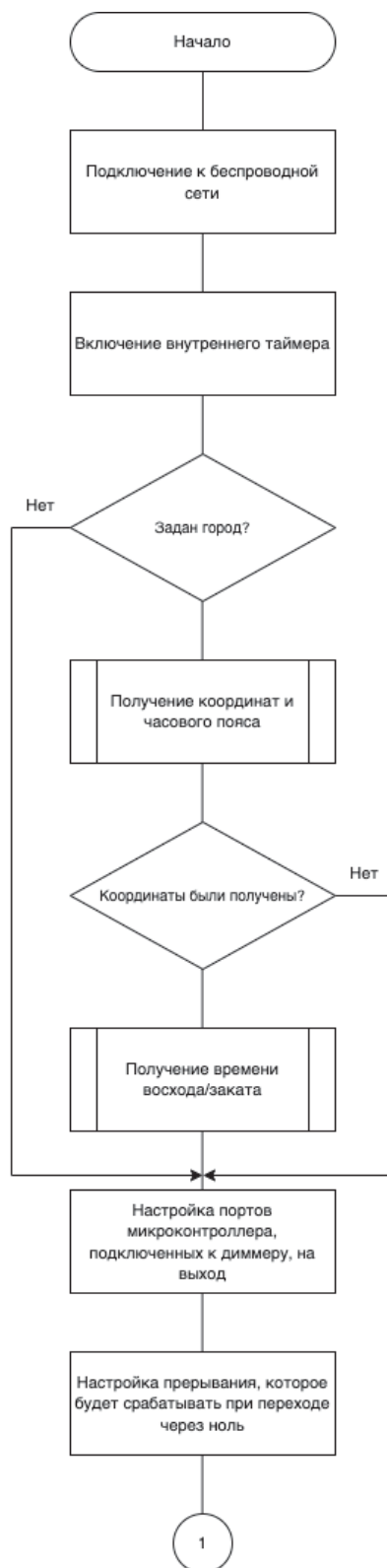
Рисунок 7 – Упрощенный алгоритм управления всей системы в целом
