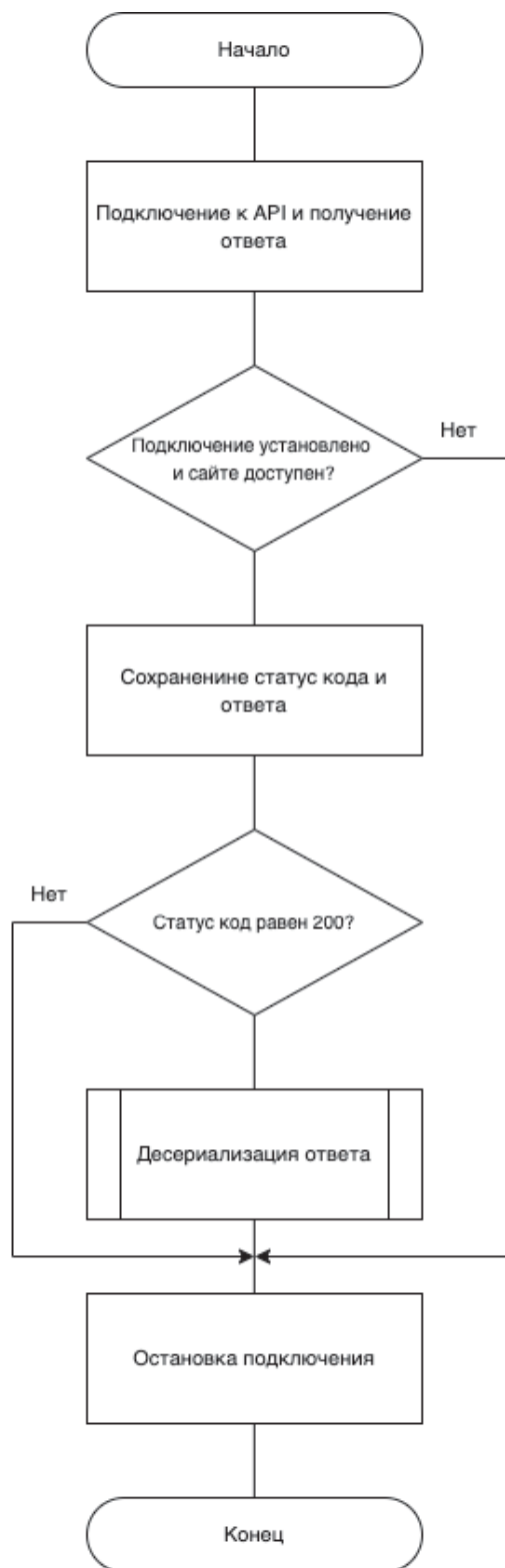
Рисунок 4 – Общий алгоритм подключения к API
