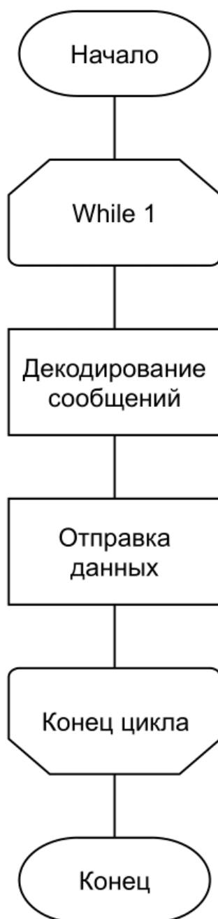
Рисунок 8 – Блок схема работы функции отправки значений
