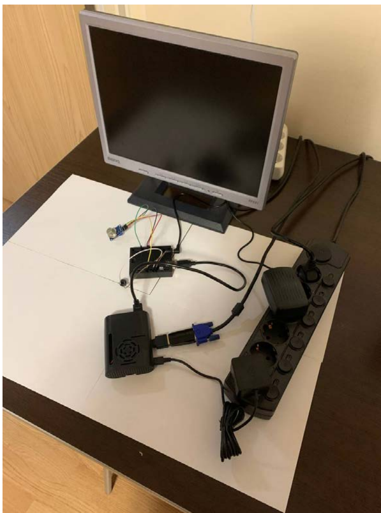
Рисунок 17 – Подключение контроллера к одноплатному компьютеру Raspberry PI 4 model B
