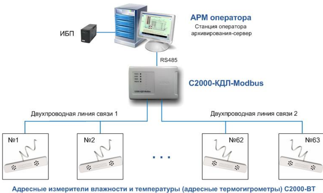
Рисунок 5 – Архитектура системы мониторинга от НПФ «Круг»
