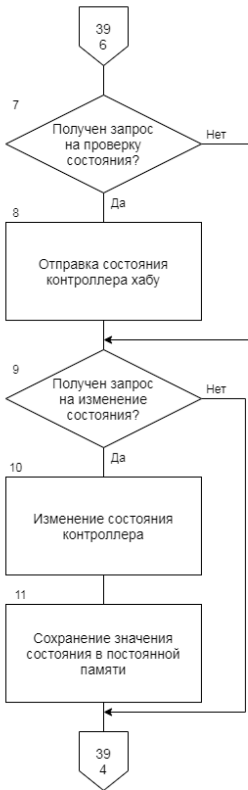
Рисунок 3.2.4 – Продолжение алгоритма работы контроллера
