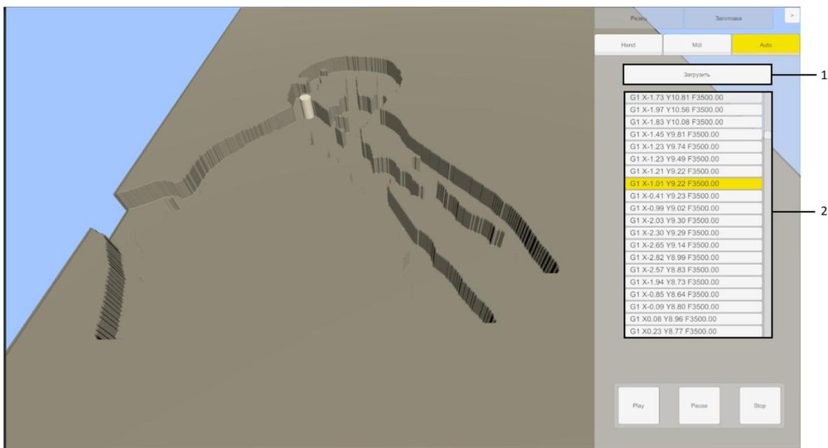
Рисунок 20 – Панель автоматического режима
