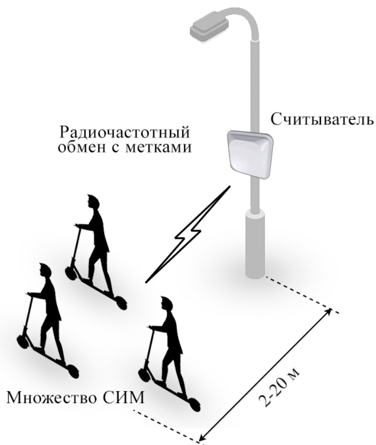
Рисунок 3.2.2 – Считывающее оборудование на опоре освещения
