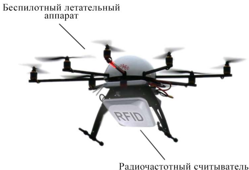
Рисунок 3.2.5 – Беспилотный летательный аппарат с RFID-считывателем
