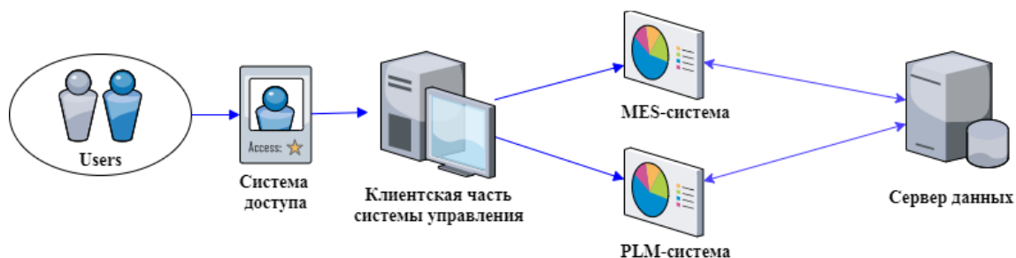
Рисунок 3 – Функциональная схема части СУ до внедрения модуля
