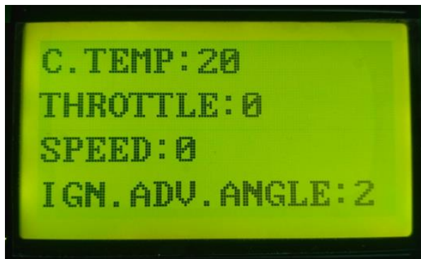
Рисунок 5.2.6. – Отображение параметров ЭСУД в реальном времени
