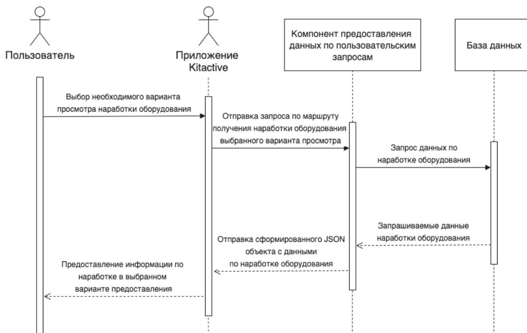
Рисунок 12 – Диаграмма последовательностей варианта использования «Просмотр учета наработки оборудования, подключенного к телеметрии»
