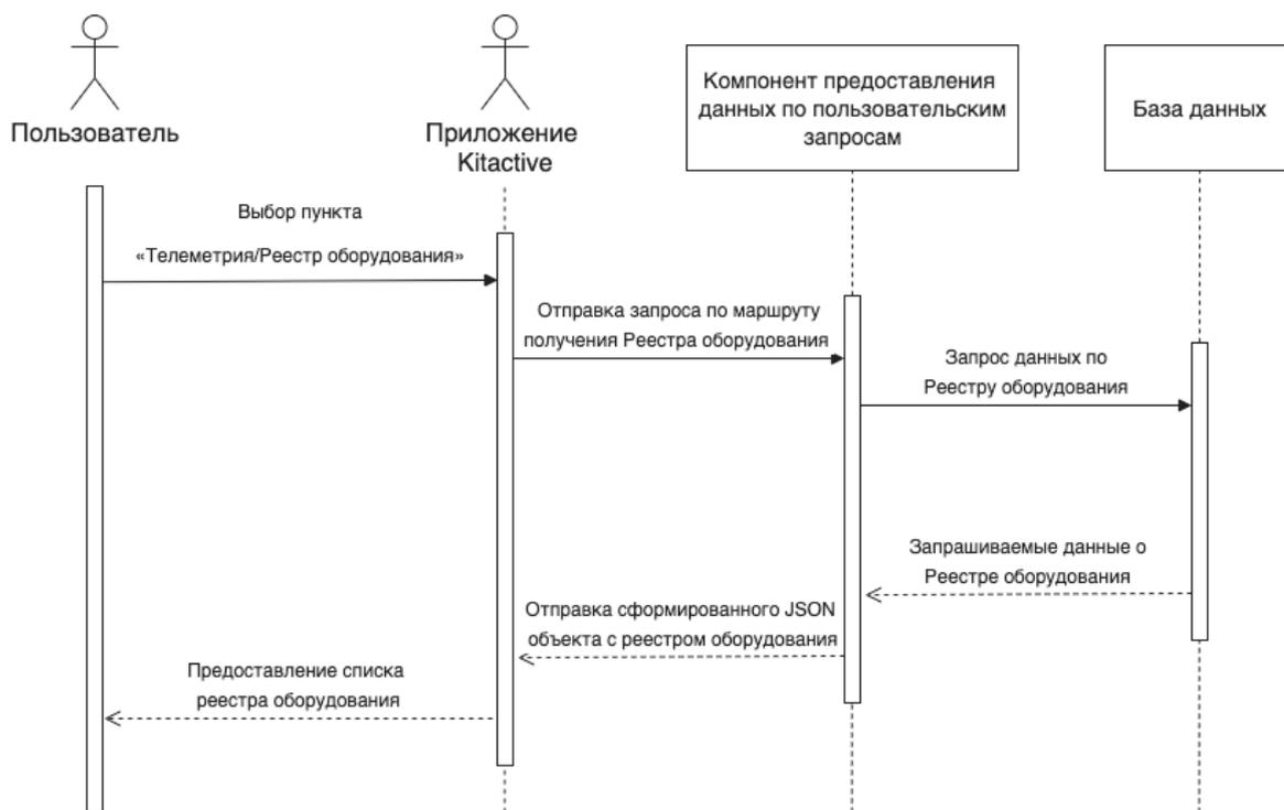
Рисунок 10 – Диаграмма последовательностей варианта использования «Просмотр реестра оборудования, подключенного к телеметрии»
