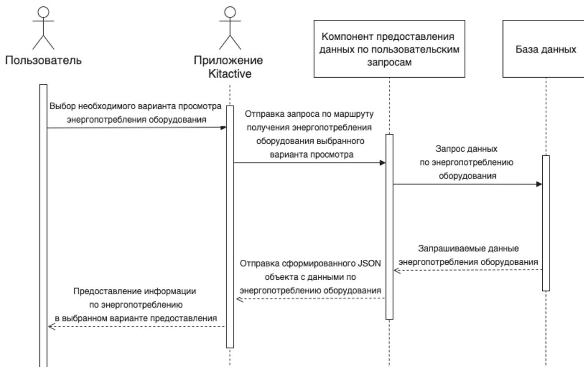
Рисунок 13 – Диаграмма последовательностей варианта использования «Просмотр учета энергопотребления оборудования, подключенного к телеметрии»
