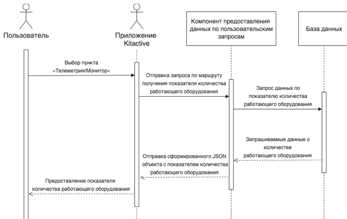
Рисунок 14 – Диаграмма последовательностей варианта использования «Просмотр количества работающего оборудования, подключенного к телеметрии, в момент запроса»
