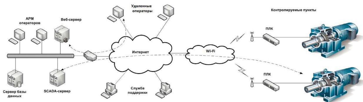
Рисунок 1.2 – Структура SCADA-системы на базе сети Интернет
