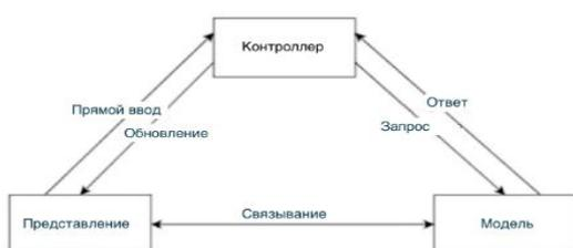
Рисунок 13 – Архитектура MVC
