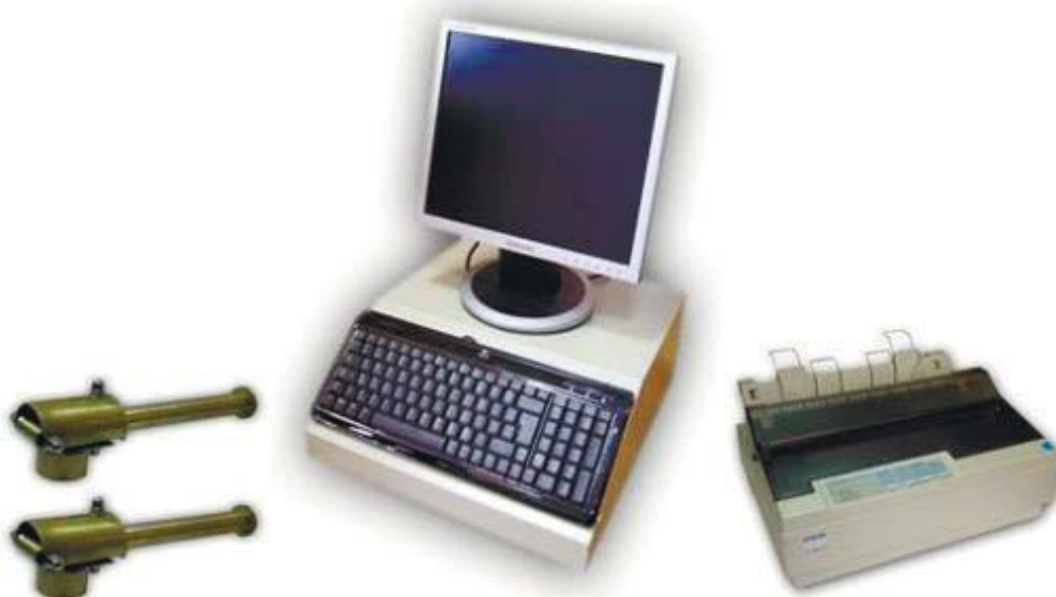
Рисунок 3 – Стенд для вибродиагностики подшипников колесных пар железнодорожных вагонов СВ–01 МВ
