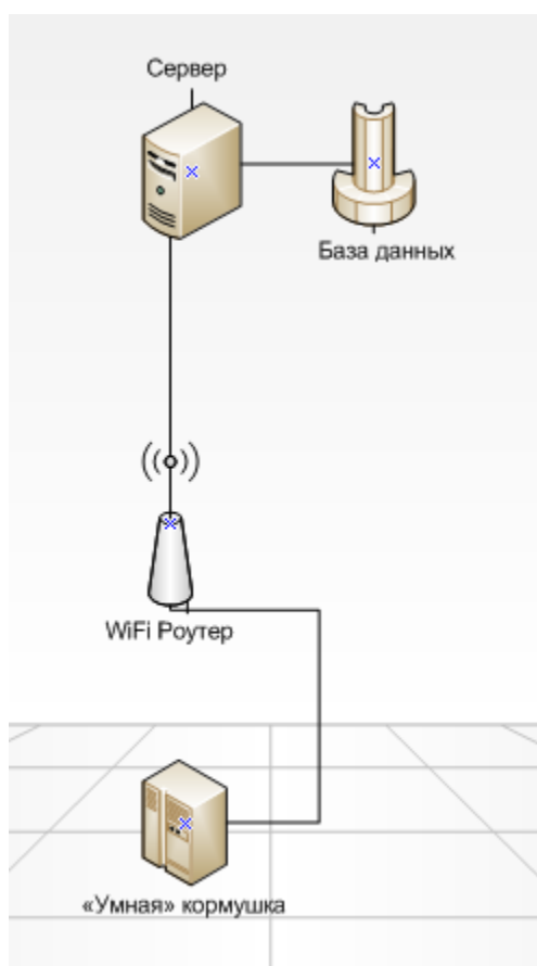
Рисунок 20 – Макромодульная часть структуры «умной» кормушки
