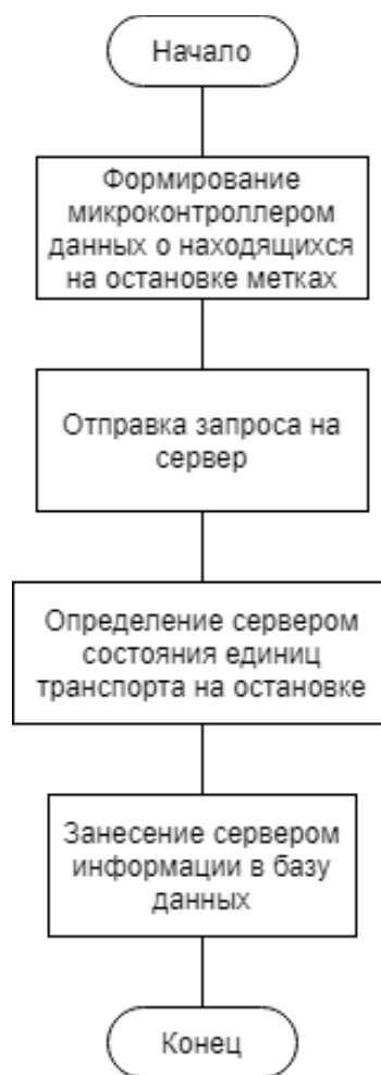
Рисунок 3.2.1 – Укрупненный алгоритм работы системы
