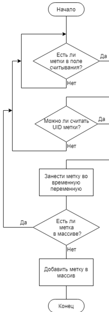
Рисунок 3.2.2 – Алгоритм основного цикла программы
