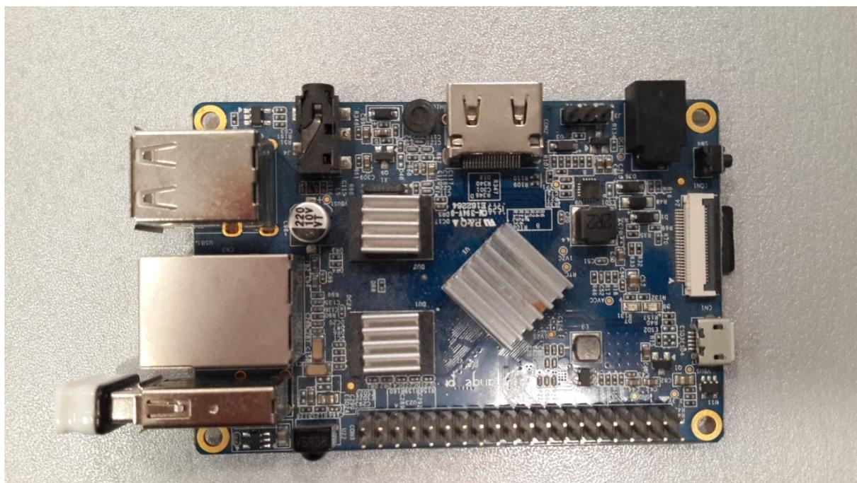
Рисунок 16 – Хост, установленный на одноплатный компьютер Orange Pi
