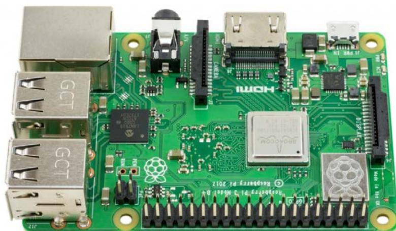
Рисунок 7 – Внешний вид платы Raspberry Pi версии B+
