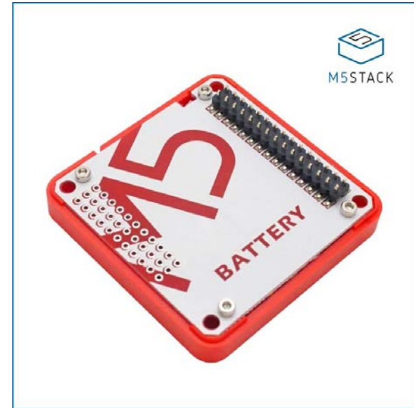
Module BATTERY. Емкость 700 мАч.
