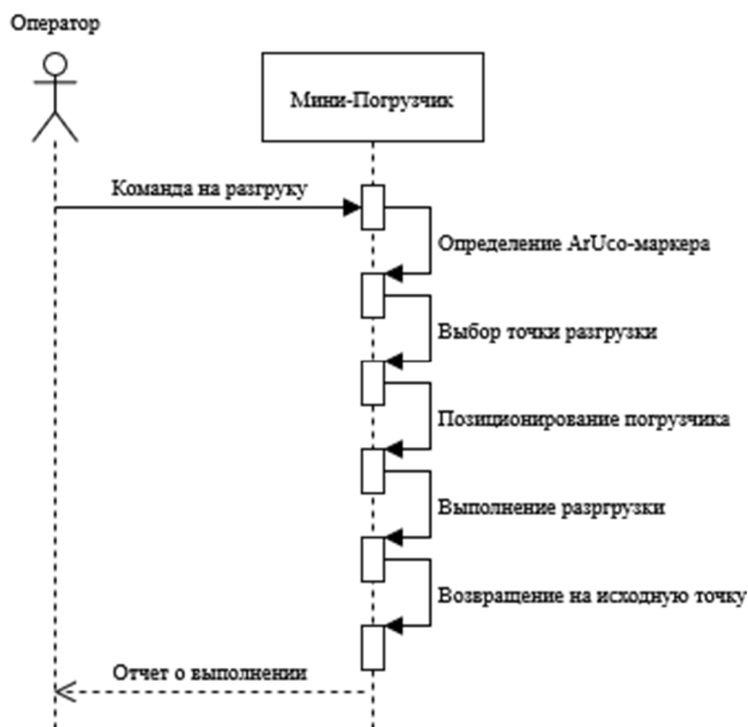
Рисунок 10 – Диаграмма последовательностей автономного модуля разгрузки мини-погрузчика (UML, ГОСТ Р ИСО/МЭК 19501-2006)
