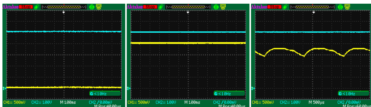
Рисунок 37 – Эксперимент с фоторезистором (500 мкс)
