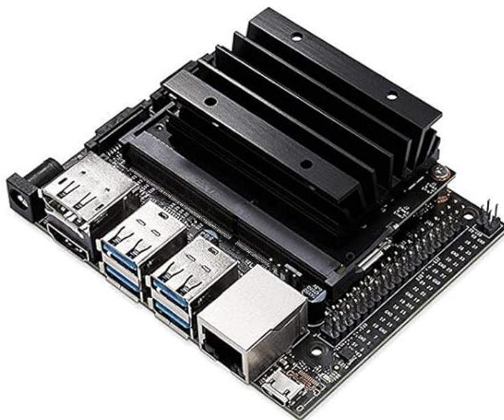
Рисунок 20 – Внешний вид компьютера Jetson Nano
