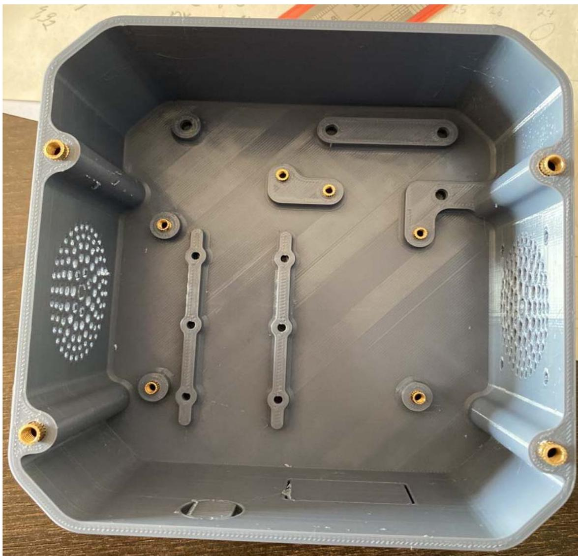
Рисунок 22 – Распечатанный корпус второго прототипа
