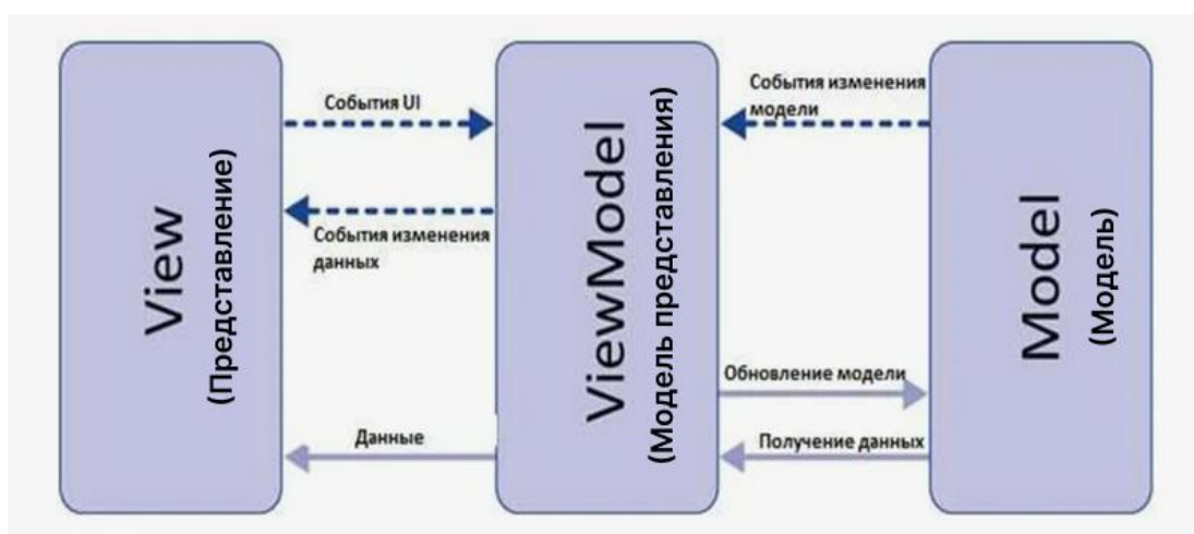
Рисунок 8 – Структурная схема MVVM
