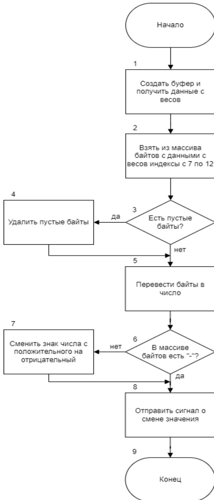
Рисунок 2.2 – Алгоритм получения значения с весов
