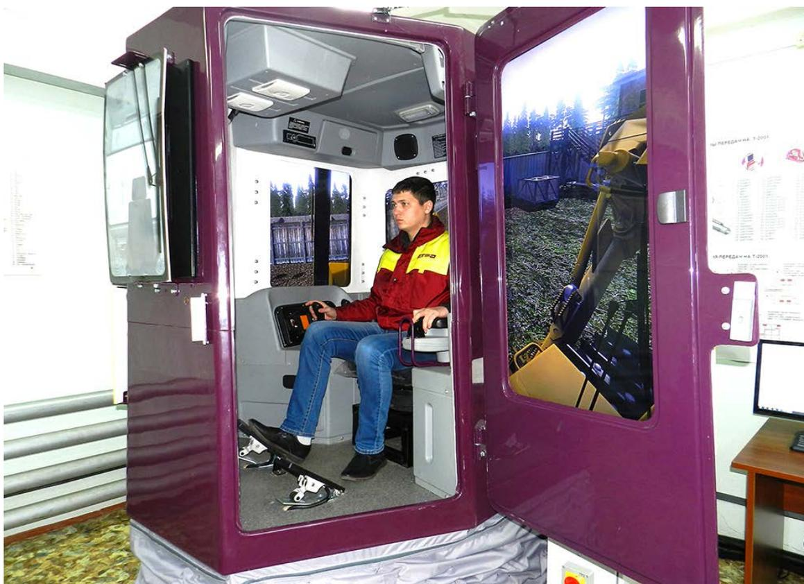
Рисунок 3 – Кабина симулятора Четра
