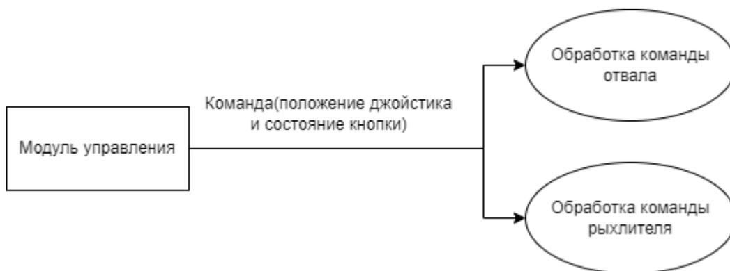
Рисунок 9 – Диаграмма потоков данных модуля движения отвала и рыхлителя
