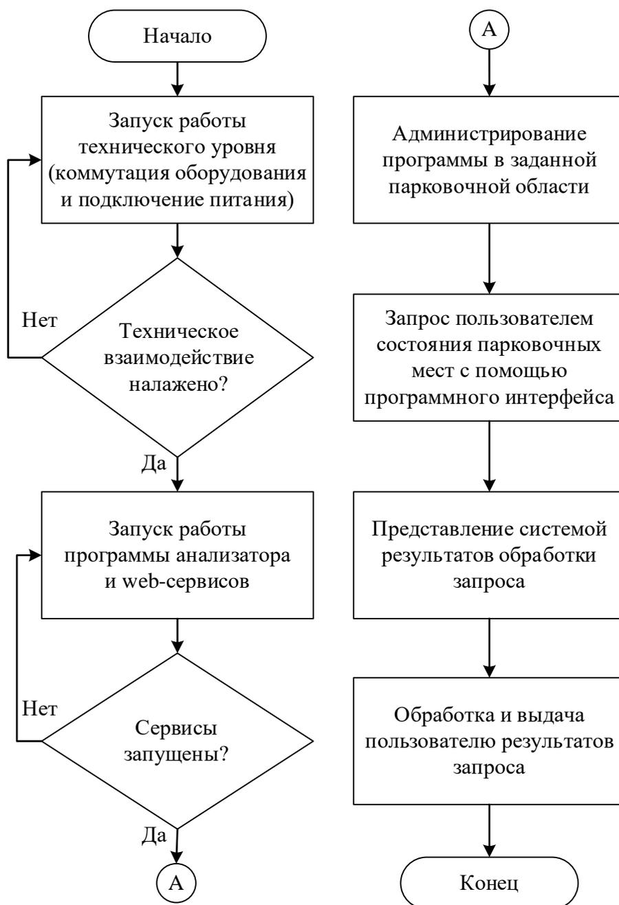
Рисунок 22 – Алгоритм запуска и работы системы
