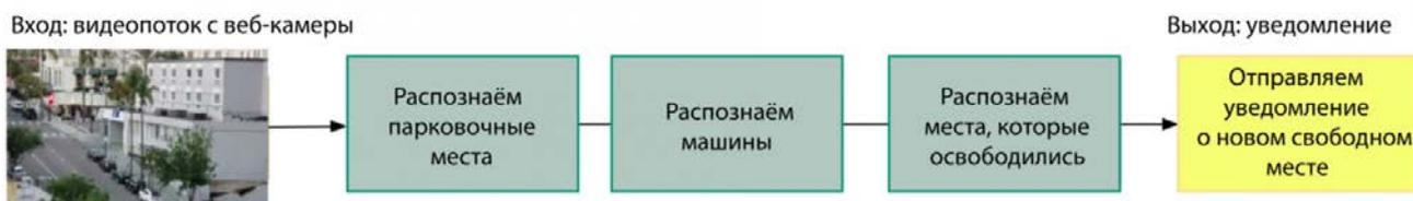
Рисунок 15 – Схематическое изображение алгоритма работы системы [29]
