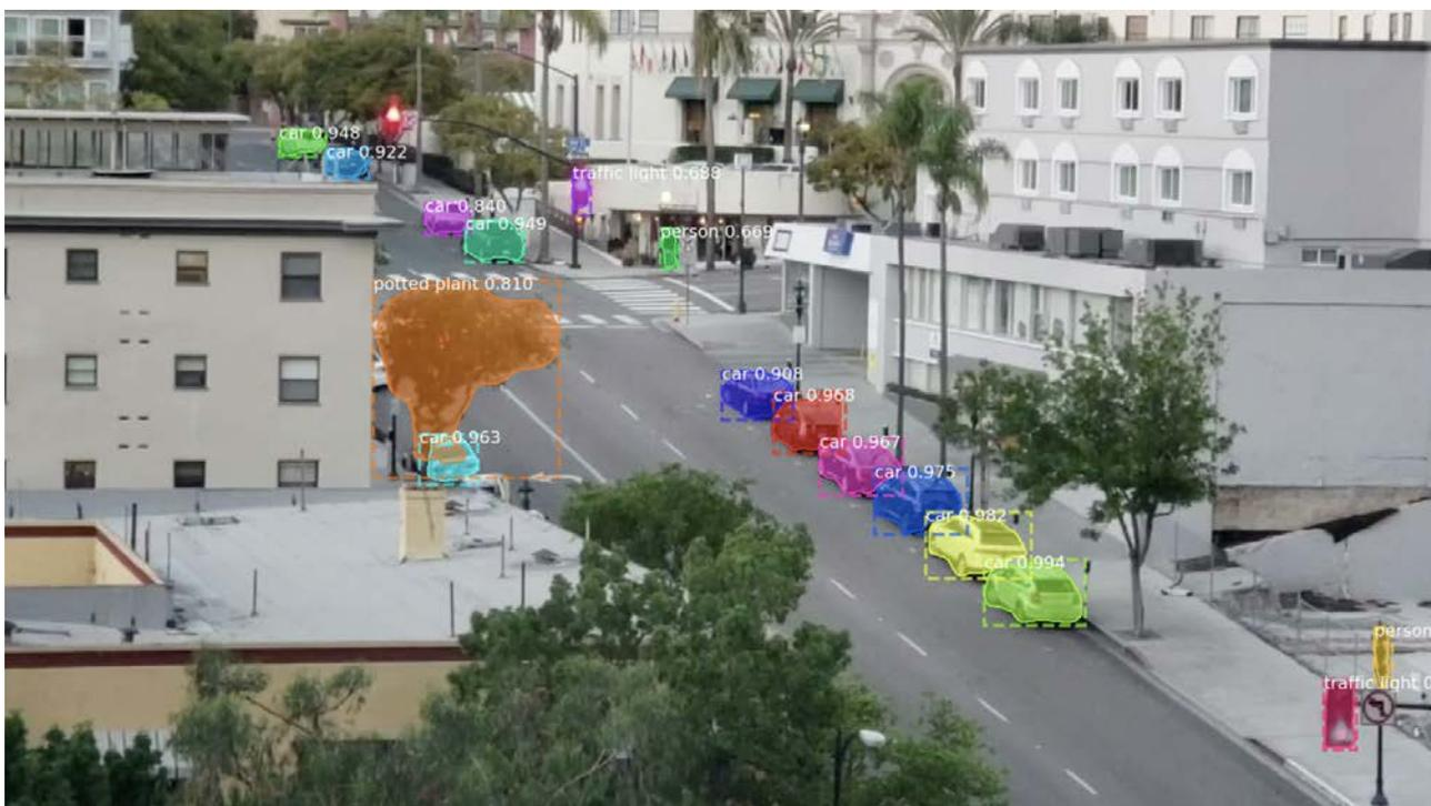
Рисунок 17 – Пример работы open-source модели от Matterport
