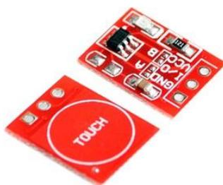
Рисунок 28 – Модуль сенсорной кнопки емкостной ТТР223
