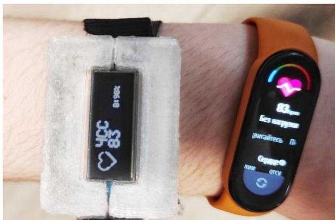
Рисунок 47 – Одновременное измерение ЧСС на двух устройствах
