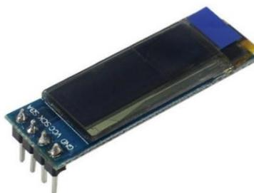
Рисунок 30 – OLED экран 0.91 дюйм
