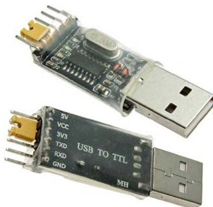
Рисунок 15 – Внешний вид преобразователя интерфейсов USB в UART на базе CH340G [18]
