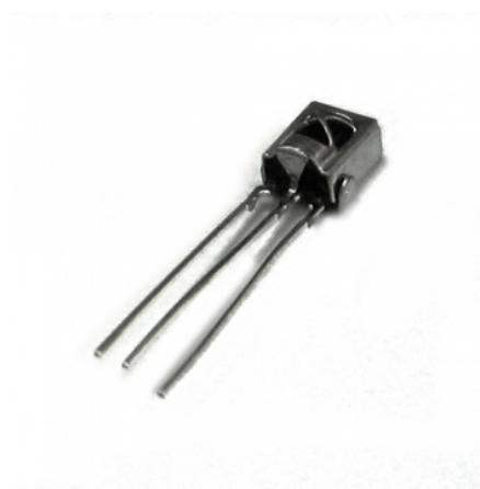
Рисунок 12 – ИК приёмник VS1838В
