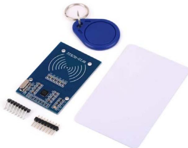
Рисунок 11 – Считыватель RFID RC522, RFID-карта, RFID-ключ
