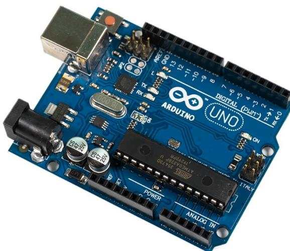
Рисунок 6 – Плата Arduino Uno R3
