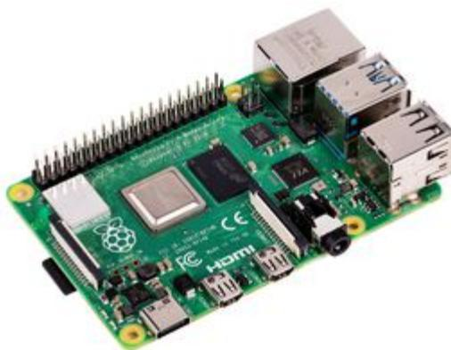
Рисунок 5 – Плата Single Board Computer, Raspberry Pi 4 Model B
