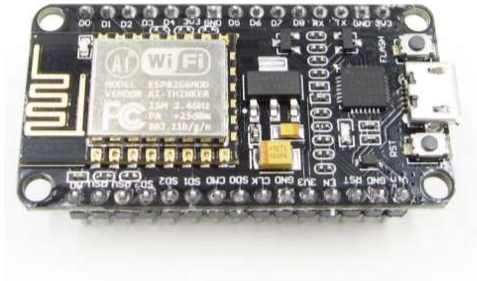
Рисунок 4.1.5.1 – Отладочная плата NodeMCU
