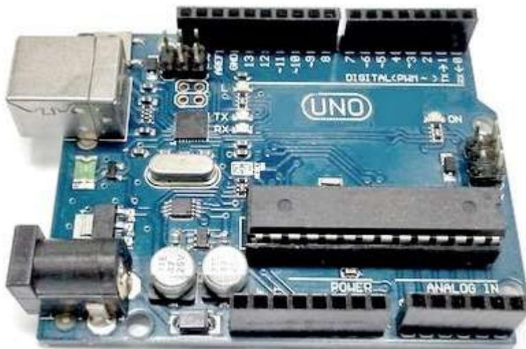
Рисунок 4.1.1.2 – Плата Arduino Uno с микроконтроллером ATmega328P
