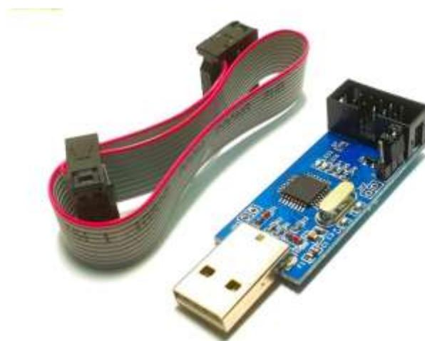
Рисунок 4.2.1 – Программатор USBasp
