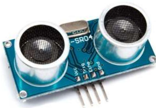
Рисунок 4.1.2.1 – Ультразвуковой дальномер HC-SR04
