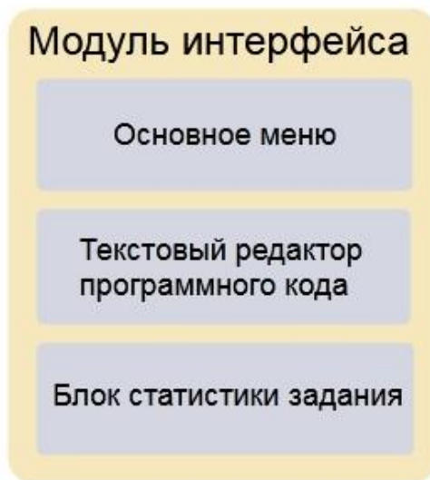
Рисунок 5 — Архитектура модуля интерфейса
