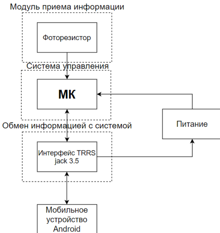
Рисунок 14 – Структурная схема принимающего модуля
